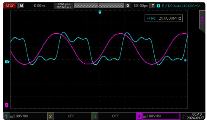
Bild 2. Vergleich zwischen Rechteckwellen des ESP32-S2 (türkis) und des UNI-T UTG962E (pink).
