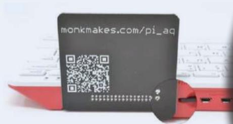
Bild 2. Air Quality Kit, angeschlossen an einen Raspberry Pi 400. (Quelle: MonkMakes)
