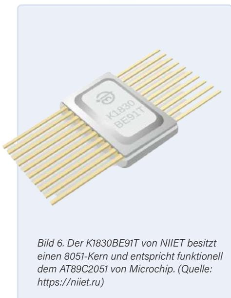
Bild 6. Der K1830BE91T von NIET besitzt einen 8051-Kern und entspricht funktionell dem AT89C2051 von Microchip. (Quelle: <https://niet.ru>)
