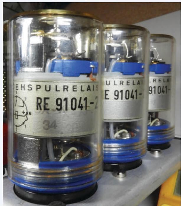
*Bild 1. Die Relais, hier von hinten gezeigt, mit ihrer Typennummer auf dem Kunststoffgehäuse.*
