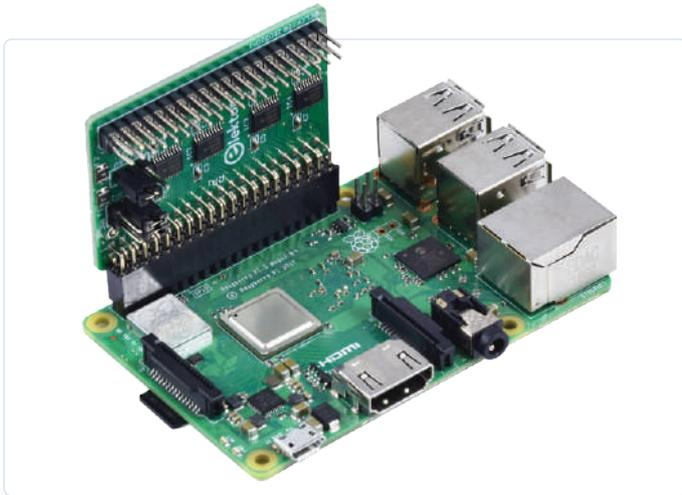
Bild 4. Die Platine kann auch mit „klassischen“ Raspberry-Pi-Boards verwendet werden.
