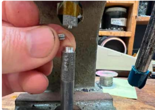
Bild 11. Selbst entworfenes kleines Presswerkzeuge.
