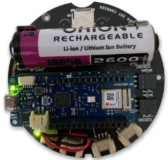
Figuur 3. De batterijhouder maakt de Oplà IoT-kit draagbaar.
