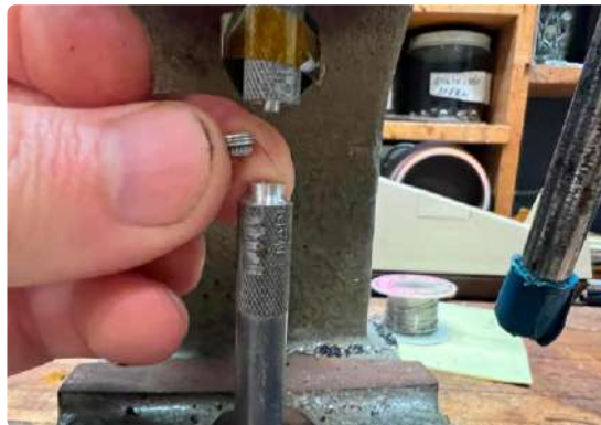
Figure 11. Outils spéciaux pour une petite presse à crémaillère.
