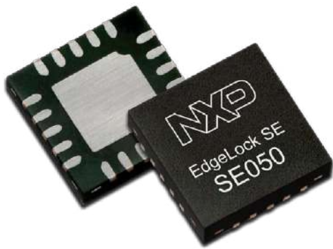
Root-of-Trust basata-su-silicio: il Secure Element EdgeLock® SE050.
