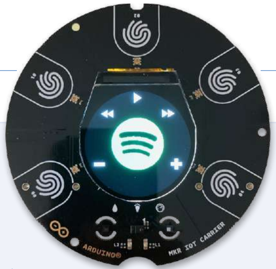
Figura 11: Le funzioni dei pulsanti sono visualizzate sul display.
