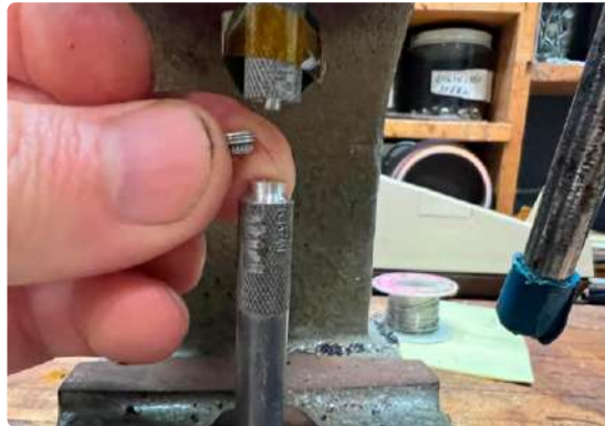
Figura 11: Personalizzazione per realizzare una piccola pressa ad arco.
