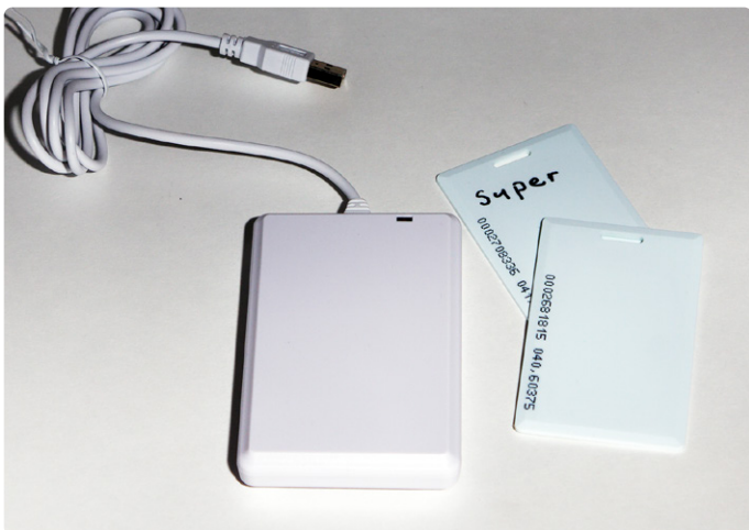
Bild 12. Ein RFID-Kartenlesegerät mit USB kann Teil des HID werden.
