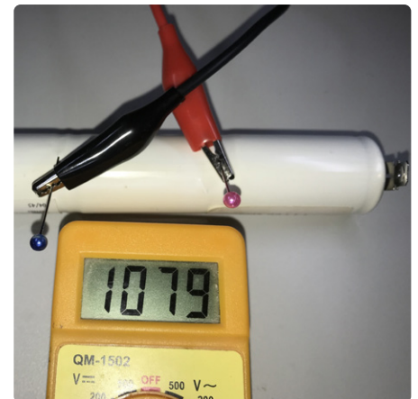
Bild 3. Verwendung von Glaskopfnadeln zur Spannungsmessung an einer NiCd-Zelle in einem Pack.
