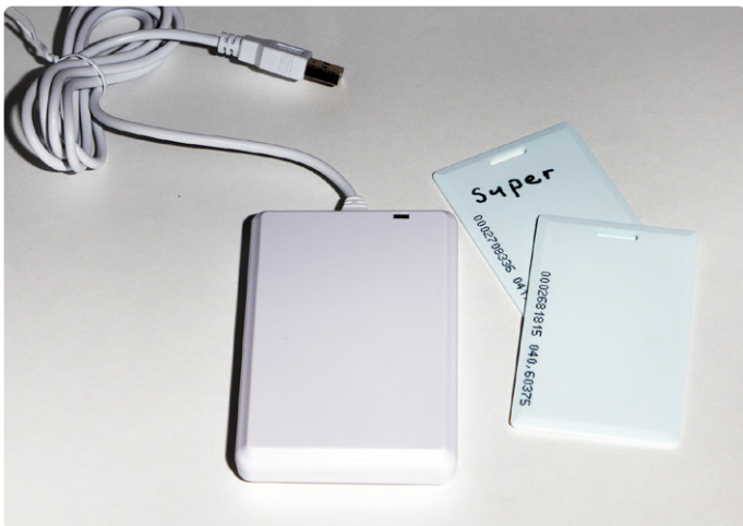
Figuur 12. Een via USB aan te sluiten RFID-lezer als onderdeel van de human interface-sectie.
