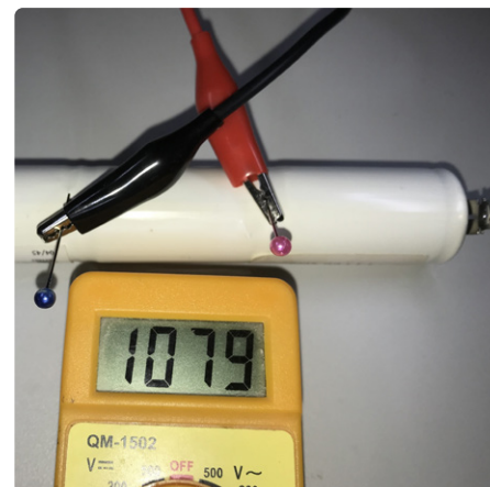
Figuur 3. Gebruik kleermakersspelden om de spanning van een NiCd-cel in een accupack te meten.
