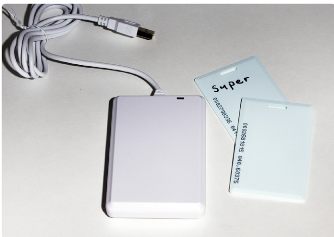
Figure 12. Un lecteur de cartes RFID contrôlé par USB a été proposé comme élément de l'interface humaine.
