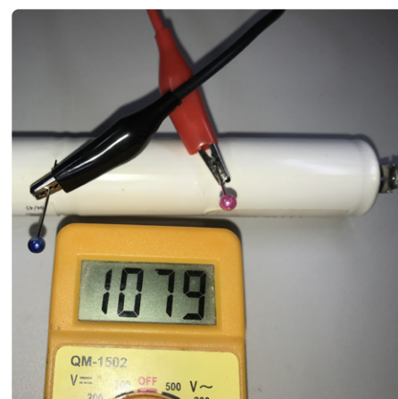
Figure 3. Utilisation d'épingles de couturière pour mesurer la tension d'une cellule Ni-Cd (plutôt plate) dans un pack.
