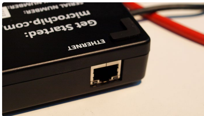
Figuur 1. Deze poort biedt ook Power over Ethernet.
