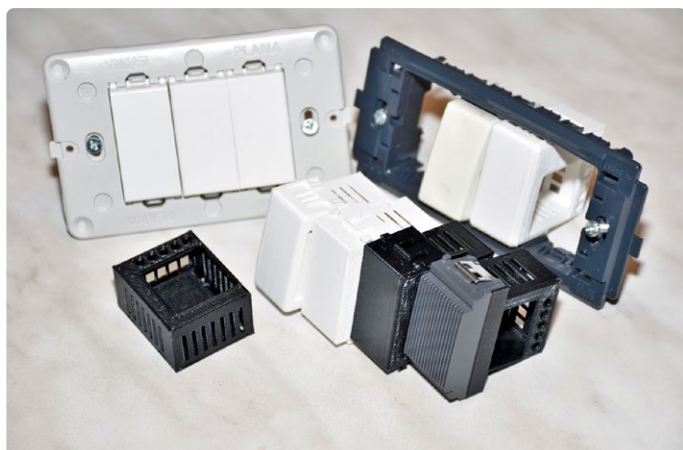
Figuur 5. 3D-geprinte behuizingen, adapters en inserts voor Vimar Plana, Vimar Idea, Gewiss Basic en Gewiss Playbus.
