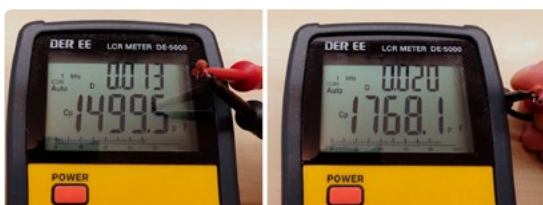
Figuur 4. Deze twee referentiecondensatoren van 1 nF zijn niet de beste.
