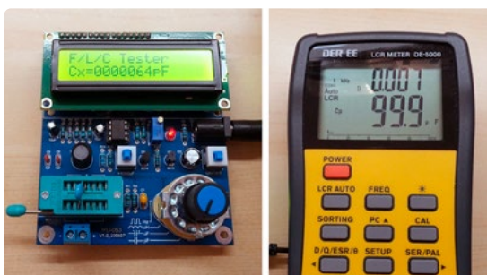
Figuur 3. Dezelfde component met twee meters gemeten – hier klopt iets niet!
