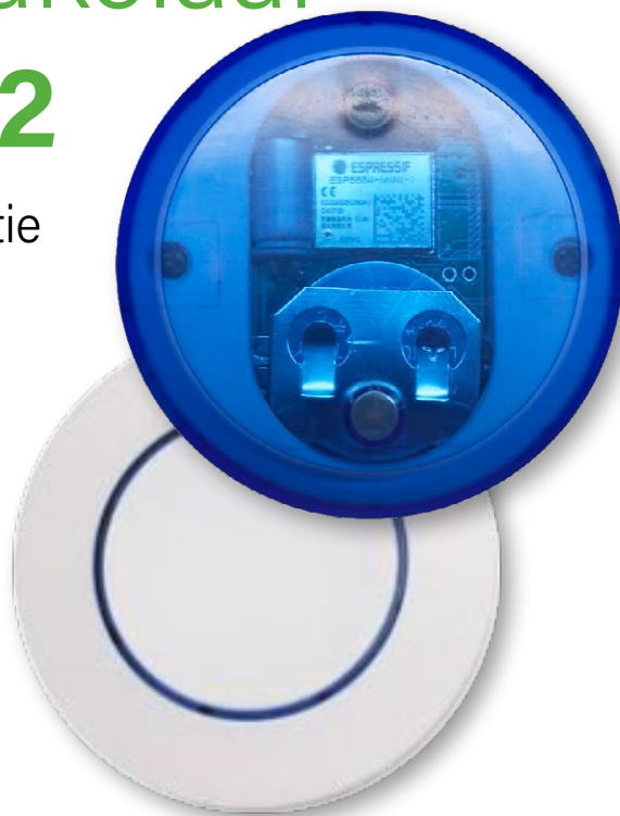
Figuur 1. De op ESP32-C2 knoopcel-schakelaar in zijn behuizing.
