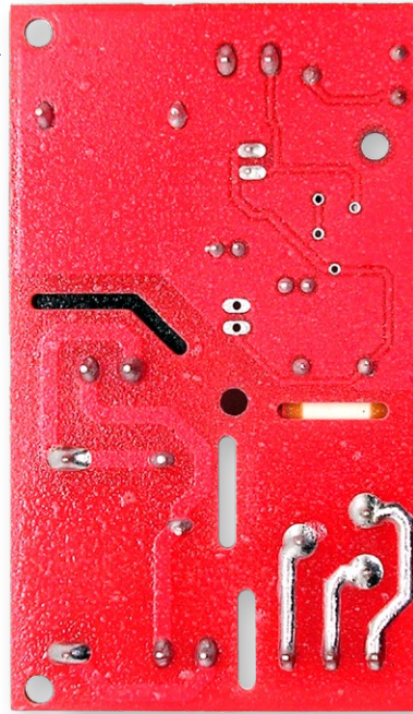
Figure 5. Côté soudure du circuit imprimé, avec les pistes épaissies visibles dans le coin inférieur droit. Cela permet de contrôler des charges plus élevées sans chauffer les pistes en cuivre.
