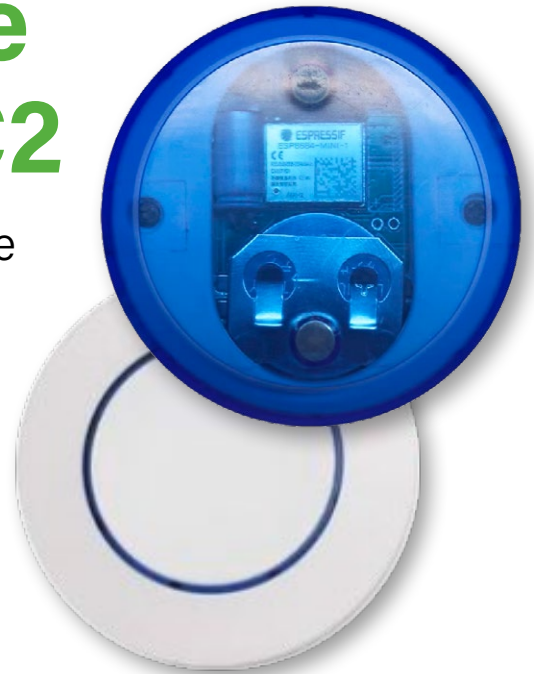
Figure 1. Le commutateur à pile bouton basé sur l'ESP32-C2 dans son boîtier.
