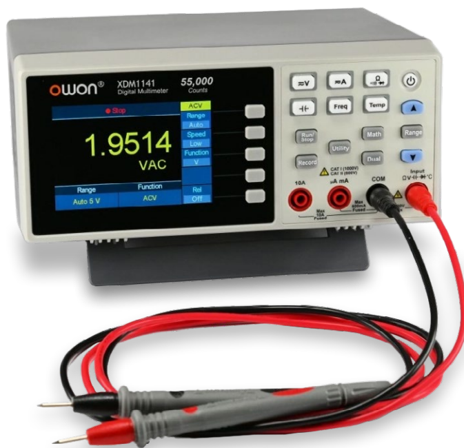
Figure 1. Le Multimètre Owon XDM1141 est livré avec un câble d'alimentation, un câble USB et des cordons de mesure munis de pinces crocodiles.
