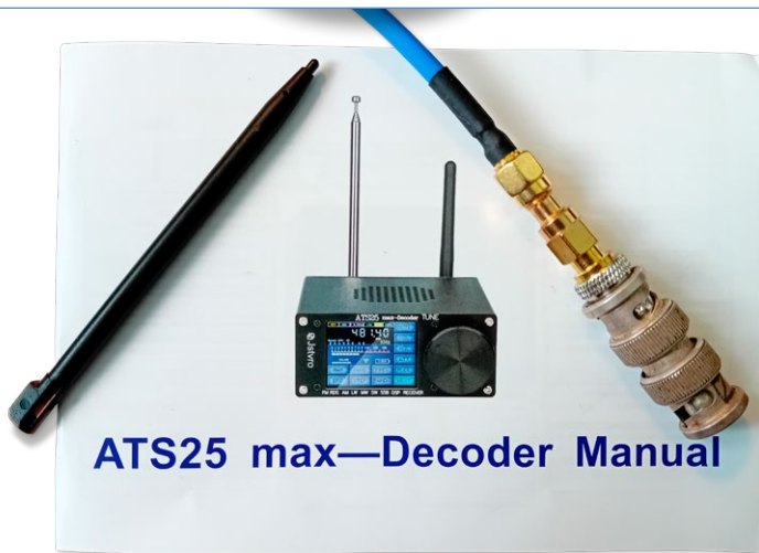
Bild 2. Mein provisorischer SMA-auf-BNC-Adapter (in zwei Stufen, aber durchgängig 50 \Omega ), der unverzichtbare Stylus (links) und das gedruckte Handbuch.
