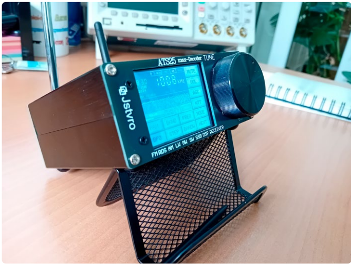
Figuur 4. Ik heb een goedkope smartphone-houder gebruikt om de ontvanger onder een comfortabele hoek vast te zetten voor een aangename bediening via het display. De stylus heeft ook een plaatsje.
