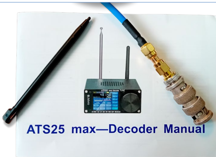
Figuur 2. Mijn geïmproviseerde SMA-naar-BNC-adapter (in twee stappen, maar overal 50 \Omega ), de onmisbare stylus (links) en de gedrukte handleiding.
