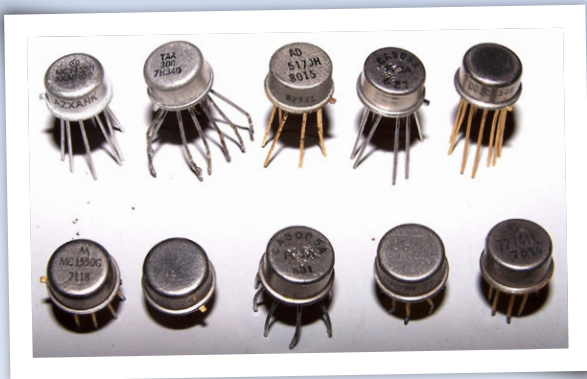
Figuur 5. TO-99 8- en 10-pins IC's.
