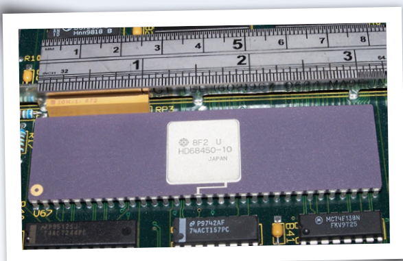
Figuur 1. HD68450 DMA-IC voor de 68000-serie microcomputers van Motorola, in een keramische behuizing.
