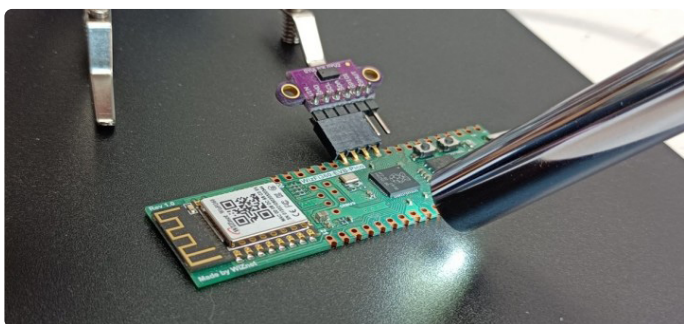
Figuur 4. Met de endoscoop plus ingebouwde LED-ring kunt u details vanuit een andere hoek bekijken. Hij kan ook in objecten kijken.
