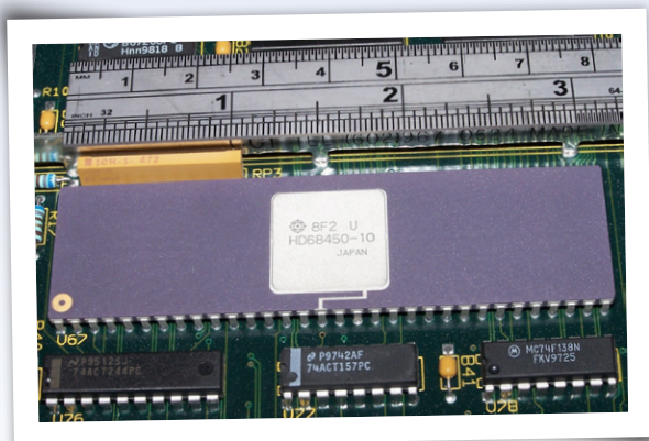
Figure 1. CI DMA HD68450 pour les micro-ordinateurs de la série 68000 de Motorola, dans un boîtier en céramique.
