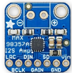
Figuur 2. De audio-versterkermodule zet digitale I 2 S-signalen om in 3W-audio.
